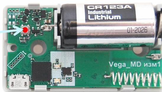
**2. Способ OTAA.** После нажатия на кнопку запуска, устройство осуществит три попытки присоединения к сети в заданном при настройке частотном плане. При получении подтверждения активации в сети LoRaWAN, устройство подаст сигнал индикатором (свечение в течение 5 секунд) и перейдет в режим «Активный». Если все попытки окажутся неудачными, датчик продолжит накопление данных и будет осуществлять попытки присоединения к сети раз в 6 часов.
